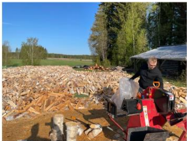
Piikkomiseen Markus Savolainen käyttää hydraulista halkomakonetta. Kuva: Jukka Eskanen / Yle
